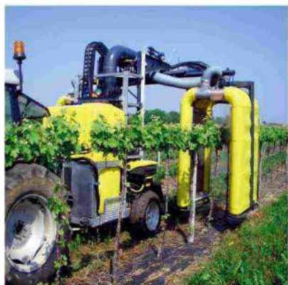
Foto 3 Riduzione dell'impronta idrica attraverso sistemi antideriva a recupero (foto a sinistra) e fasce tampone (foto a destra) che limitano la contaminazione dei corpi idrici adiacenti
