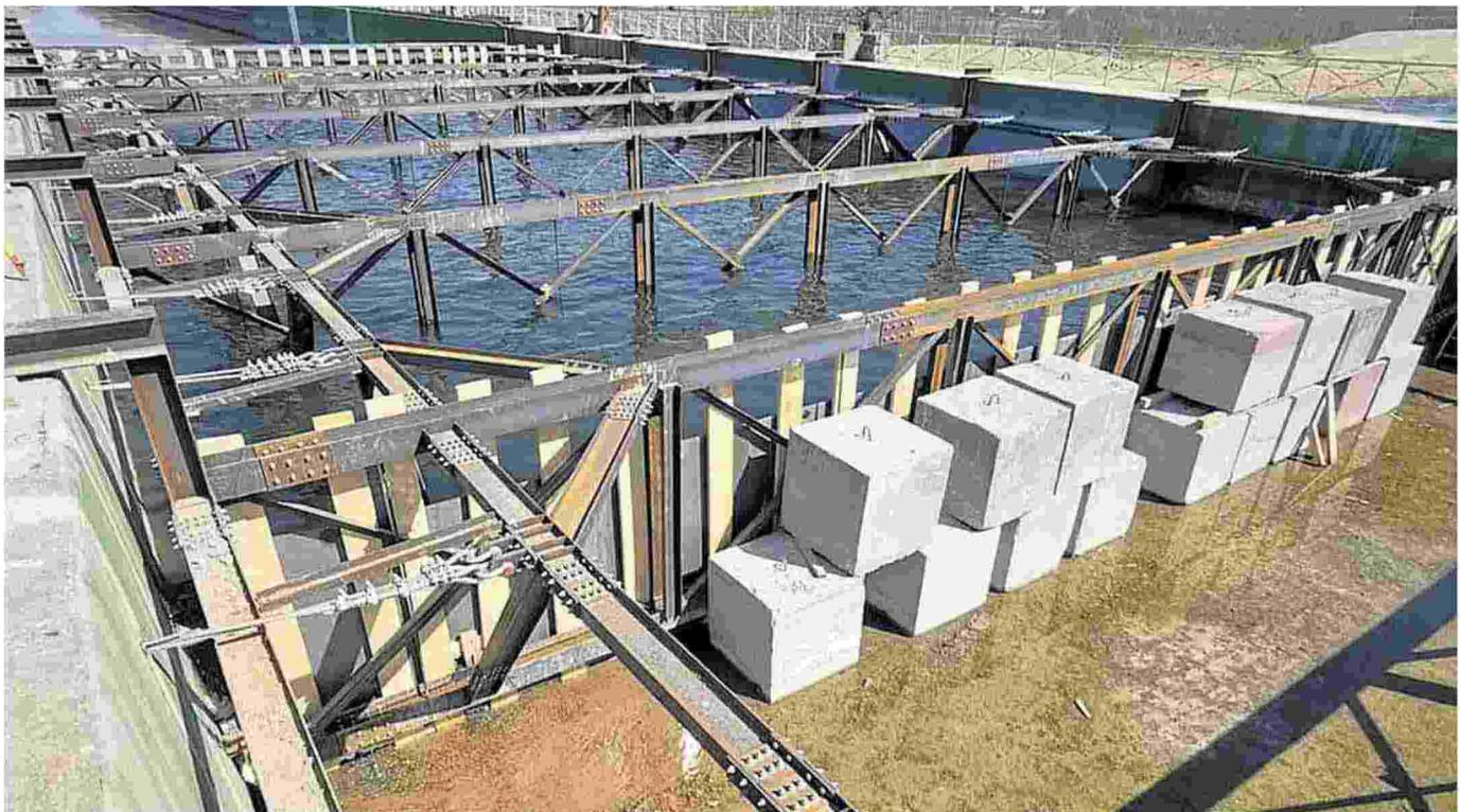
Il collaudo è avvenuto con blocchi di cemento posizionati all'estremità del pontecanale: sono state isolate le porzioni ripristinate e in 3 ore sono state fatte tre simulazioni di carico d'acqua
