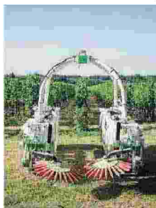
Ted Il robot contadino in grado di agire nei vigneti con pendenze fino al 30%
