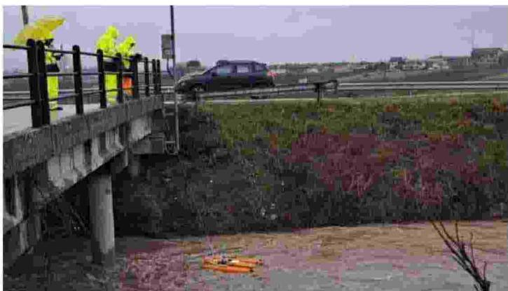
**Febbraio 2024** Tecnici dell'Arpav utilizzano un misuratore di portata sul torrente Alpone
