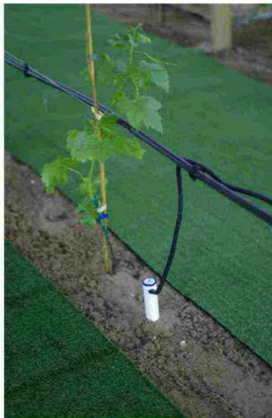
Sonda per la misurazione di umidità, temperatura e salinità. Permette di eseguire misurazioni a diverse profondità, e garantisce una corretta gestione delle risorse, con un notevole risparmio in termini di acqua, energia e fertilizzanti
