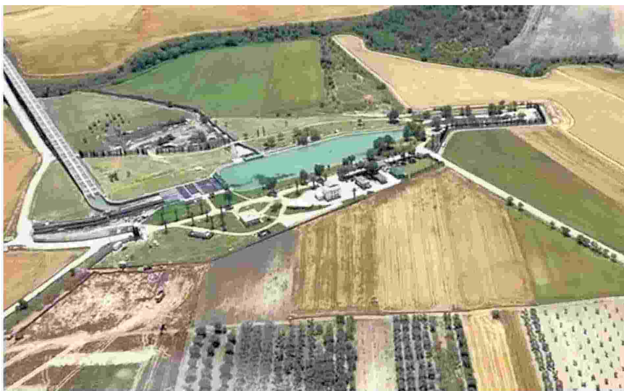
Finocchito Il ripartitore che regola i flussi tra Aqp e impianti irrigui. Nella foto piccola, un impianto dei Consorzi
