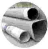
Tubi in amianto in una foto d'archivio
