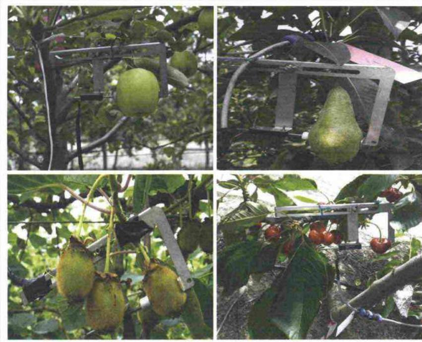
▲ Fig. 2 - "Fruttometro", sensore per la misura accurata e continua della variazione diametrica dei frutti, montato su varie specie di fruttiferi.
