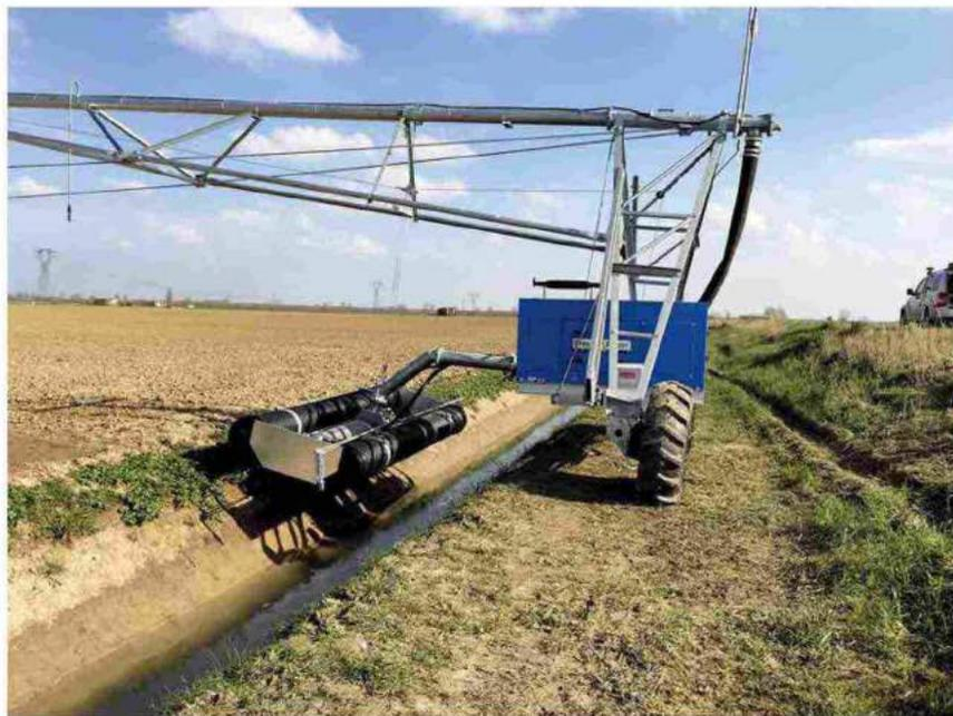
**Foto 3** Sistema «linear» ad avanzamento frontale
