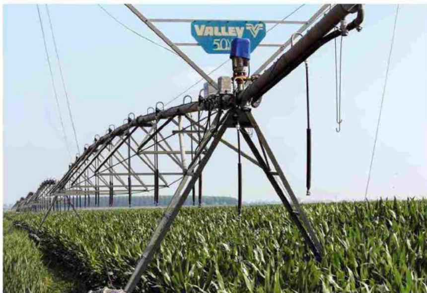
**Foto 2** Sistema «pivot» con irrigatori installati su calate ed equipaggiato con sistema di irrigazione di precisione
