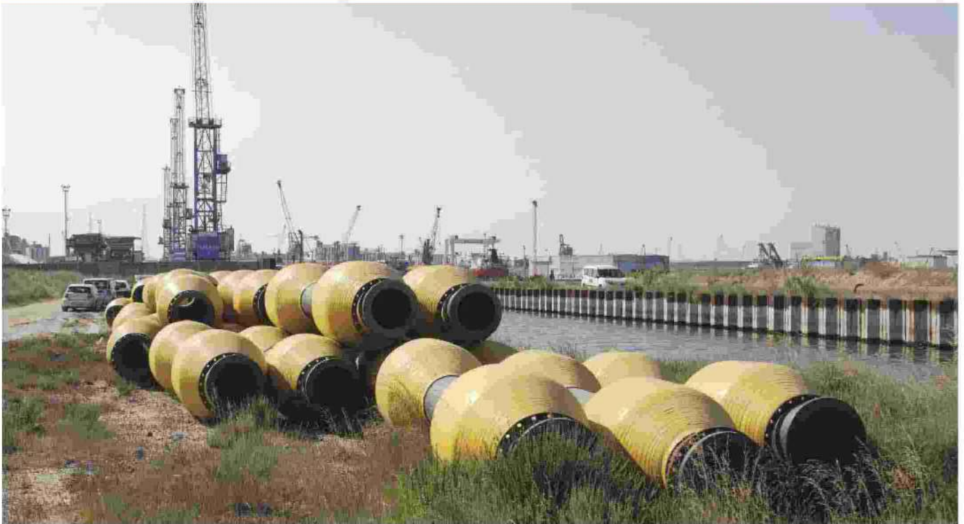
I galleggianti posizionati in questi giorni per sostenere i tubi di condotta della draga tornata in azione alla pialassa FOTOSERVIZIO MASSIMO FIORENTINI
