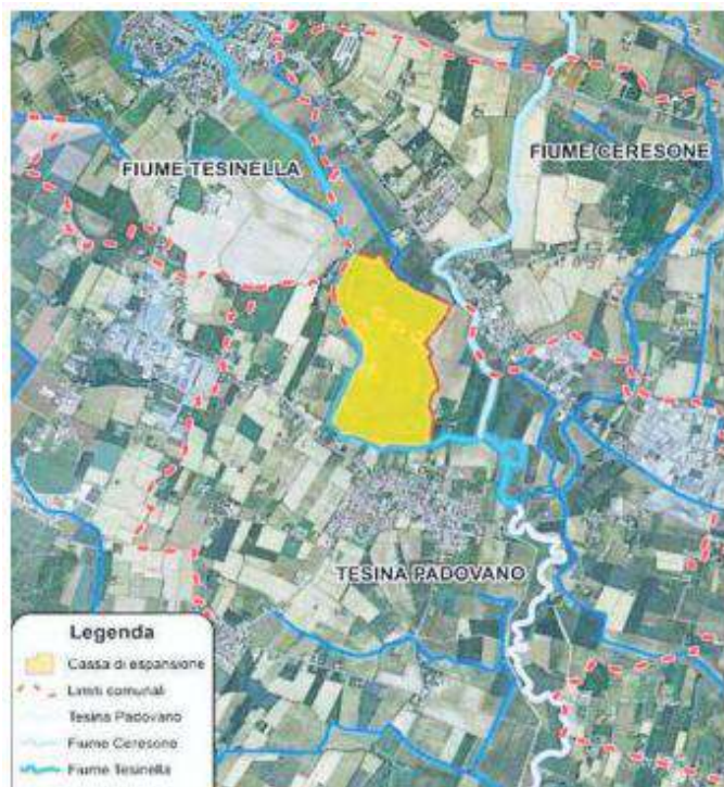
La cartografia, in due scale diverse, che indica la cassa di espansione progettata su sessanta ettari di terreno fra Mestrino e Veggiano
