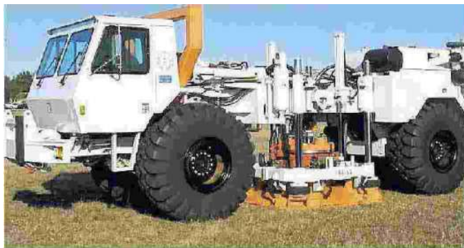
Un veicolo Vibroseis, utilizzato per le ricerche di idrocarburi
